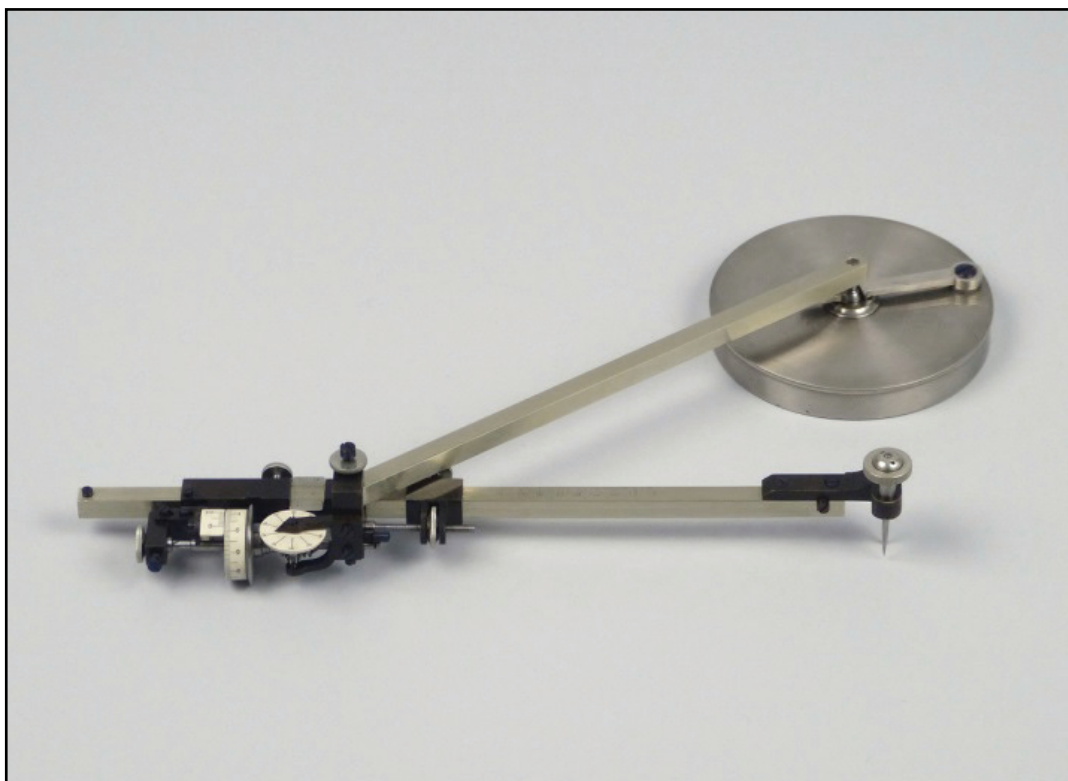
1883-as kiadású polár planiméter a svájci Otto & Coradi precíziós műszereket gyártó manu-faktúrától. (Kép forrása: http://www.mathinstruments.ch )
